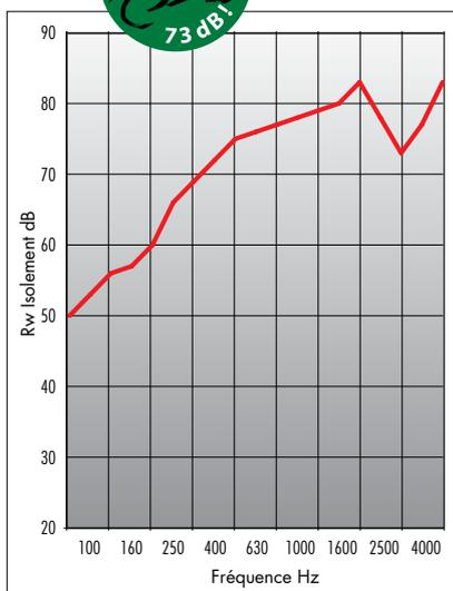
— Cloison double ossature métallique et chanvre celluleuse :
