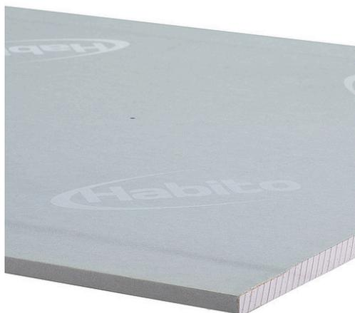
La plaque Habito® Hydro est une plaque de plâtre de haute qualité destinée au parachèvement à des applications parachèvement au sec dans des pièces humides adaptée au confort de vie contemporain. Elle est composée d'une âme de plâtre incombustible enrobée sur les deux faces d'un carton spécial particulièrement robuste et est produite suivant NBN EN 520:2009.
