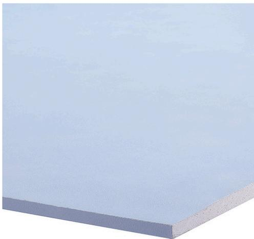
La plaque Glasroc H est une plaque de plâtre destinée au parachèvement sec. La plaque est constituée d'une âme en plâtre modifiée et renforcée de fibres de verre aux propriétés anti-humidité et anti-moisissures améliorées, revêtue d'un coating hydrofuge spécial et est armée d'un voile de fibre de verre, suivant NBN EN 15283-1:2009.
