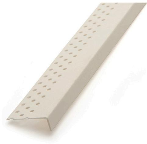
AquaBead® L-Trim est un profilé d'arrêt en forme de L, avec une très haute résistance aux chocs pour les plaques Gyproc® d'une épaisseur de 12,5 mm au minimum, composé d'une âme en copolymère sur une bande en papier perforée, dont la face intérieure est revêtue d'une colle à hydro-activation.
