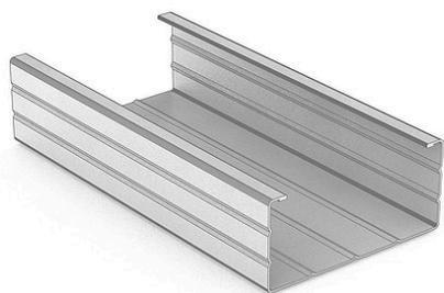
Le profilé Plagyp® PC60/27 est un profilé en forme de C pour le système de plafond Plagyp® à utiliser en combinaison avec les plaques Gyproc® destinées au parachèvement à sec. Le profilé est laminé à froid suivant NBN EN 14195:2015, en acier thermozingué (Z100 suivant NBN EN 10346:2015) avec une épaisseur de 0,6 mm, dimensions de 60 mm x 27 mm et une longueur de 3000 ou 4000 mm.
