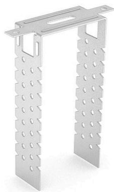
PlaGyp® PU60/125 est une suspenste universelle pour profilés PlaGyp® PC60/27 destiné au parachèvement intérieur. L'étrier pliable pour fixation directe sur tout type de support est laminé à froid suivant NBN EN 14195:2015, en acier galvanisé à chaud (Z100 suivant NBN EN 10346:2015), est pourvu de perforations d'un diamètre de 5 mm et est à plier sur le chantier.
